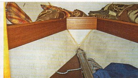
MUFF IM VORSCHIFF Eingelagertes Material hat zu wenig Luft an die Bordwand gelassen - sie ist verspakt
