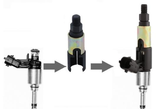
La (les) nouvelle(s) buse(s) et toutes les pièces démontées peuvent ensuite être remontées. En plus, le filtre à carburant devrait également être changé simultanément pour prévenir l'encrassement de l'installation.
